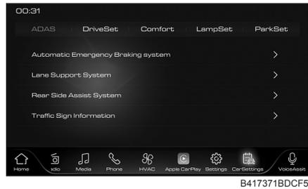
**【Automatic Emergency Braking system】** : puede activar o desactivar la asistencia de seguridad contra colisiones y la asistencia de seguridad para peatones; puede configurar la sensibilidad de advertencia de colisión.
