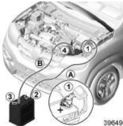
Fije el cable positivo (+) **A** en el borne (+) **1** de la batería descargada, después en el borne (+) **2** de la batería que suministre la corriente.
