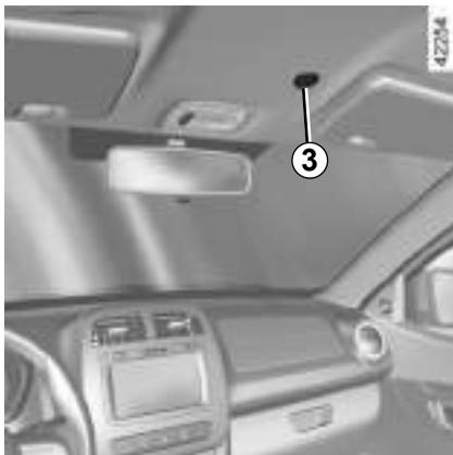
Para los vehículos equipados con un sistema de navegación, utilice el micrófono **3**.
