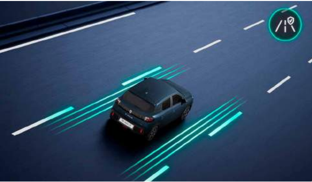
Asistente de mantenimiento de carril Aplica una corrección en el volante para mantener el vehículo dentro del carril si no activas la señal de giro.
