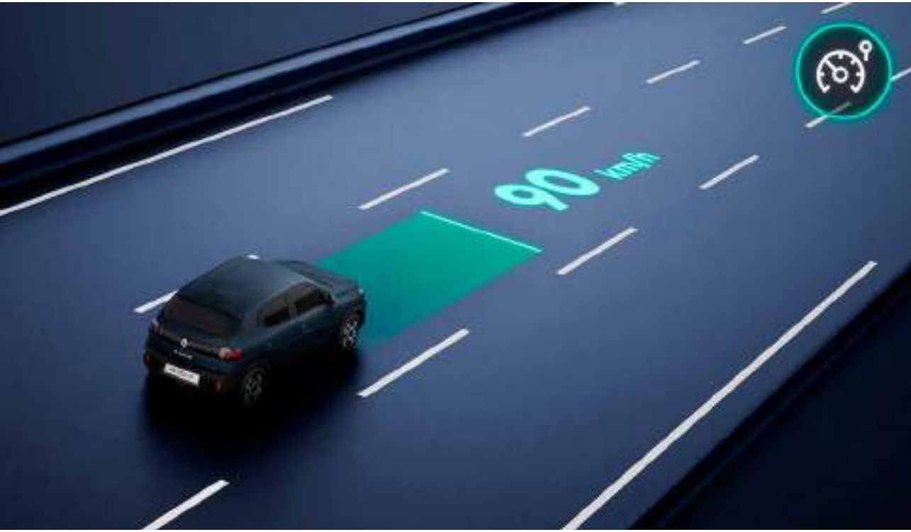
Limitador de velocidad Permite fijar una velocidad máxima para evitar sobrepasarla.
