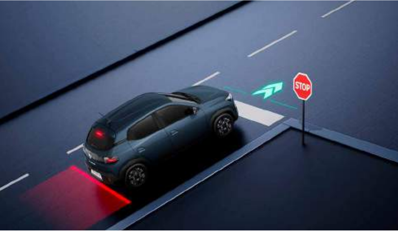
Asistencia para arranque en pendiente el sistema para arranque en pendientes mantiene el vehículo detenido en inclinación, dándote tiempo para arrancar de manera segura sin desplazarte hacia atrás
