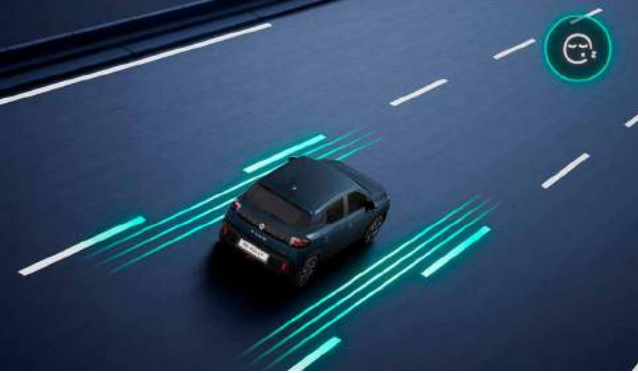
Alerta de atención del conductor El sistema informa al conductor sobre una posible falta de atención o somnolencia.
